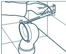
**1. "S" dirsek yerine monte edilip metal lama ile duvara montajı yapılır.**
