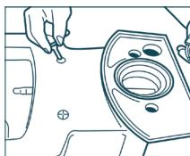
**6 - 7. Reservuar, taharet borusu ve klozet kapak montaj vidası montajı yapılp su sızdırmazlık testi yapılır. / Cistern, bidet hose and toilet seat cover mounting screws are screwed and water leakage test is performed.**
